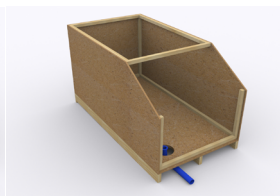
Figura 11. Listones verticales y superiores para afianzar tableros
